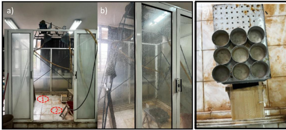
Şekil 8. a) Yağmurlama sistemi (Saksıların konumları kırmızı dairelerle belirtilmiştir) b) Metrekareye düşen yağmur miktarını hesaplamak için kullandığımız kalibrasyon kapları (Orijinal)
